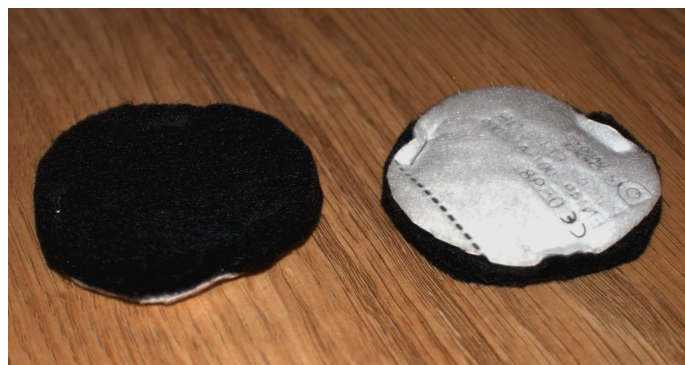
Figure 2: Cartouche à base de masques FFP2 et de (deux couches de) filtre à charbon actif d'habitacle de voiture.
